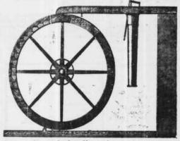
Roue hydraulique à augets.
